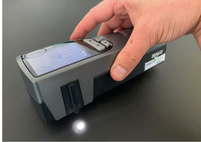
Abb. 1: Die Lichtquelle eines Spektralfotometers orientiert sich ebenso an dem idealisierten D50, wie die für den Einsatz in der grafischen Industrie entwickelten Normlichtröhren gemäß ISO 3664-2009. Somit korrelieren Farbmessdaten mit der menschlichen Farbwahrnehmung unter Normlicht D50.
