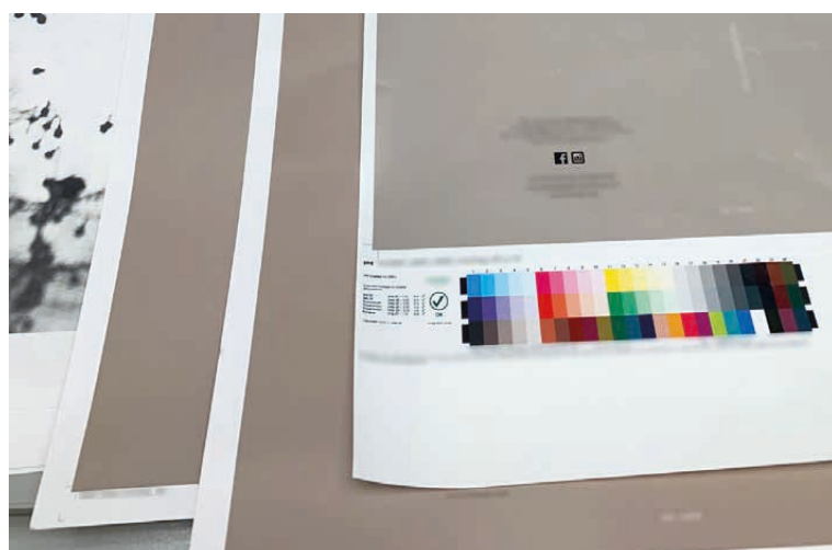
Abb. 5: Im Bild zu sehen sind Proof (rechts) und Auflagendruck (Mitte, links) eines Druckjobs mit einer homogenen Fläche, bestehend aus Anteilen von C, M und Y. Die Fläche ist nicht nur schwierig homogen zu drucken, sondern auch anfällig für Metamerieeffekte. Unter verschiedenen Lichtsituationen wirkten Proof und Druck sehr unterschiedlich zueinander.
