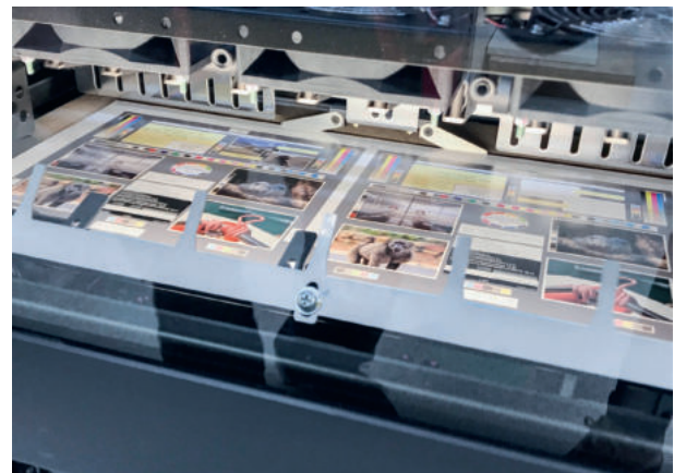
Die QSD-Druckform in zwei Nutzen auf dem Druckbogen der Jet Press 750S im B2-Format
