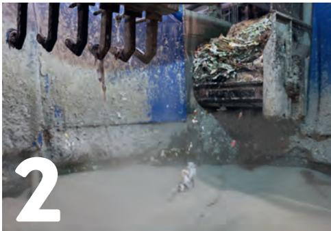
Im sogenannten Pulper wird das Altpapier durch Scherkräfte (Faser-Faser-Reibung) aufgelöst und an die weitere Stoffaufbereitung übergeben.
