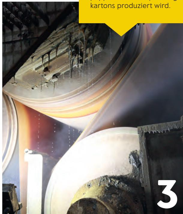
Ein dünnes Gemisch aus Stoff und Wasser wird über eine Arbeitsbreite von 7,50 Meter auf ein Sieb verteilt. So entsteht das Papier, aus dem die Wellpappe für die Verpackungskartons produziert wird.
